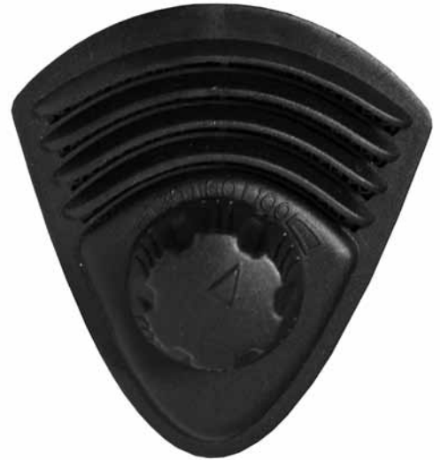
2 pav. Oro įleidimo sklendės reguliavimas: sukanč rodiklį į dešinę oro srautas didinamas
